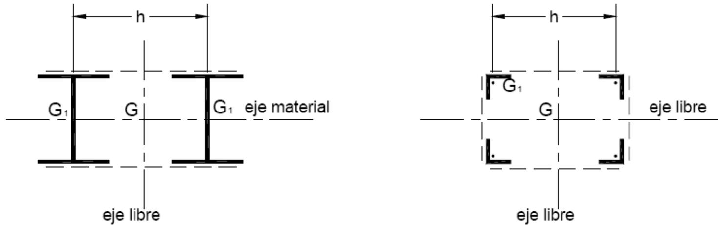
*Figura A-E.4.1. Eje libre y eje material.*
